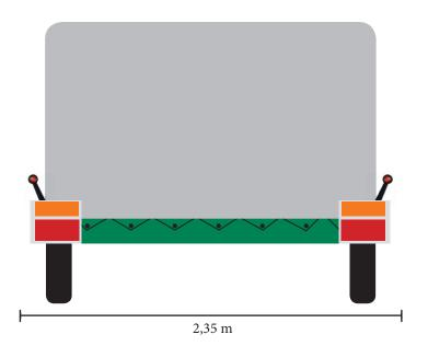
Pesant plus de 500kg, la remorque dispose d'une carte grise et de sa propre plaque d'immatriculation Le poids total en charge ne dépassant pas 750 kg, le permis B est suffisant.
